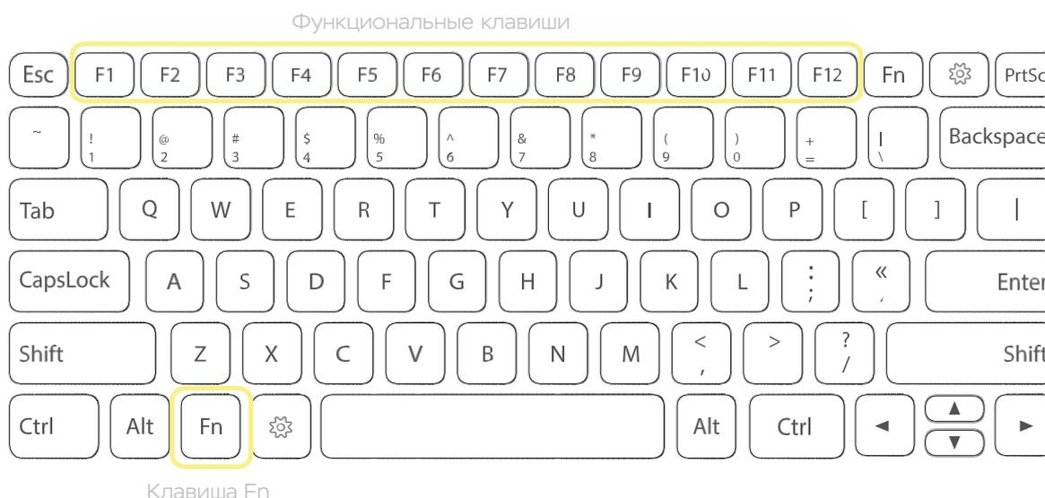
Функциональные клавиши F1-F12 выполняют функции, определяемые программными приложениями. Эти же клавиши, при одновременном нажатии дополнительной клавиши Fn, выполняют функции управления режимами ноутбука (комбинации «горячих клавиш»). Пиктограммы выполняемых функций нанесены на соответствующих клавишах. Если установлен драйвер «горячих клавиш», то при нажатии «горячей» клавиши в левом верхнем углу экрана отображается значок соответствующей функции и состояние.
